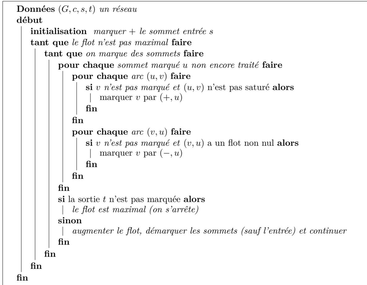
Algorithme 1 : Algorithme de Ford-Fulkerson
