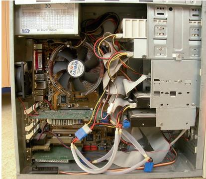
**Le processeur est fixé derrière le ventilateur pour être refroidit efficacement.**
