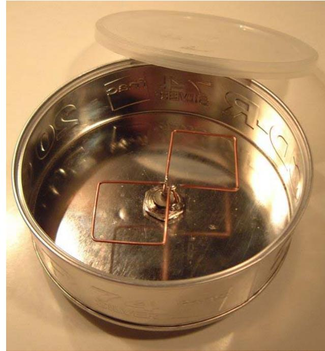
Les antennes ricorés permettent une émission du signal jusqu'à 6 km (environ 10 bd)! En 802.11b => permet la création de réseaux sans fil citoyens (gratuit)
